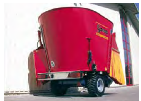
Optional: Schieber vorne rechts und hinten links für gleichzeitigen und beidseitigen Austrag.
