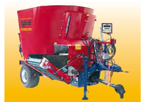
Optional: Klappbares Zusatzförderband in verschiedenen Längen, zum Beschicken von hohen Trögen. Hier in Kombination mit schmalen Querförderband (eingeklappt ohne größere Außenbreite).
